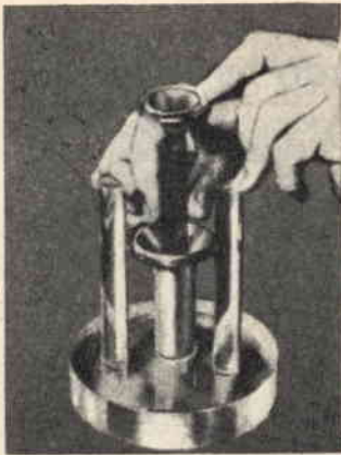
Fig. 6 - Esempio di modello, fortemente ingrandito, di un Nuvistor; la figura illustra chiaramente il montaggio degli elementi che compongono la valvola.
